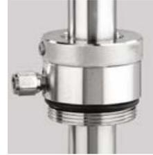
Die Fassverschraubung gasdicht verhindert den Austritt von gesundheitsgefährdenden Gasen aus dem Fass. R 2" Stahl-Feingewinde, Rückschlagventil mit Anschluss 1/8". Messing vernickelt, Dichtungen aus FKM.
