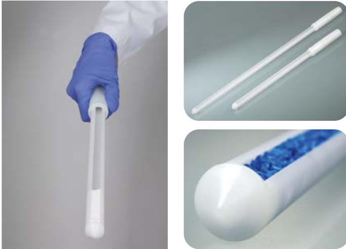
Einweg-Probenehmer für Pulver und feinkörniges Schüttgut. Durch die geschlossene Spitze kann das Probengut nicht wieder aus der Probenlanze herausrieseln. DispoPicker ist ideal für Querschnittsproben geeignet.
