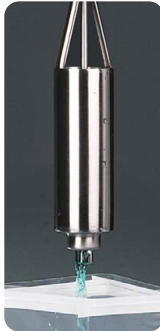
Zum Entleeren der Probe wird das Ventil mit dem Daumen geöffnet.
