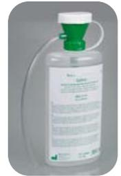
Ungefüllte Flasche für 600 ml Inhalt, durch Kippventil und Staubschutzkappe auslaufsicher. Anleitung aufgedruckt, aus transparentem PE.
