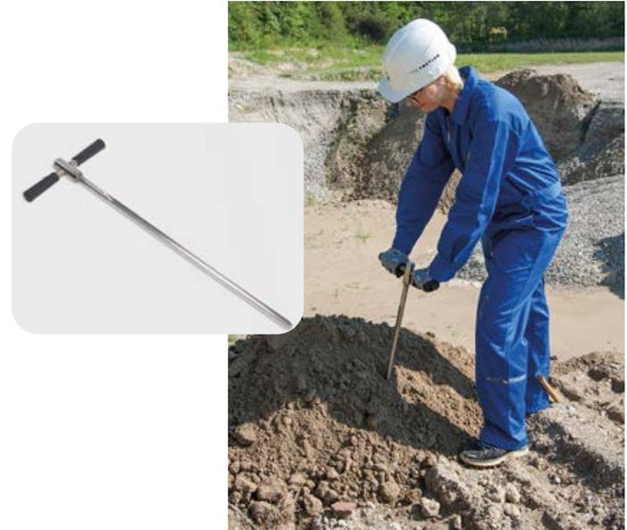
Sehr robuster Pürckhauer-Probenehmer für schwere und steinige Böden. Die ab 60 cm konisch zulaufende Spitze beim Modell 5350-5018 ermöglicht ein wesentlich einfacheres Zurückziehen des eingeschlagenen Probenehmers. Ideal auch für die Nmin-Probennahme 0–90 cm.
