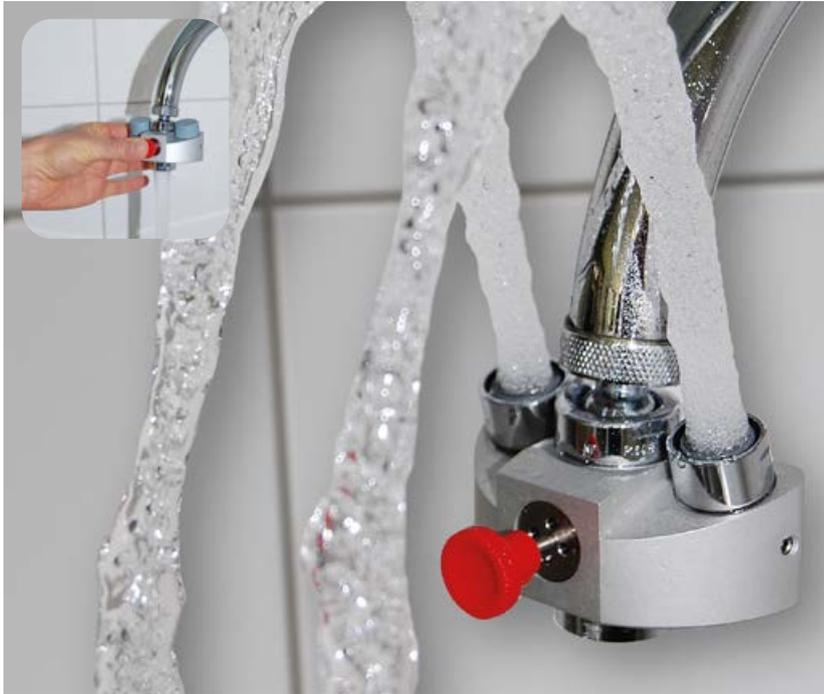
Mini-Augendusche ideal für Labor, Abfüllstationen oder alle Arbeitsplätze, an denen mit aggressiven Stoffen gearbeitet wird. Eyes Fresh lässt sich auf jeden herkömmlichen Kaltwasserhahn montieren. Durch Knopfdruck kann von Augendusche auf Perlwasser zum Waschen umgestellt werden (wird beim Schließen des Wasserhahns wieder auf AugendusCHFunktion zurückgestellt). Passend für Wasserhähne mit Außengewinde M22x1, 1/2" oder 3/8".
