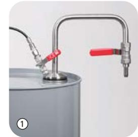
Mit dem Entnahmesystem für Lösemittel lassen sich hochreine Flüssigkeiten schnell und unkompliziert abfüllen. Mittels Druckgas (Druckluft oder Stickstoff) wird ein Überdruck im Gebinde hergestellt, der die Flüssigkeit aus dem Behälter fördert. Die Bedienung über Druckgas bietet den Vorteil, dass der Anwender ohne Mühe auch große Mengen entnehmen kann und dabei beide Hände frei hat, um das Lösemittel abzufüllen.
