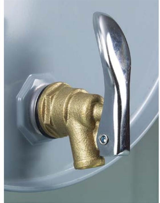
Fasshahn für petrochemische Flüssigkeiten, schließt selbstständig bei Nichtbetätigung (erhöhte Sicherheit), Gewindeanschluss 3/4" außen.
