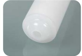
Einfacher Einweg-Probennehmer zur Entnahme von dünnflüssigen Medien. Wenn die DispoPipette geöffnet in die Flüssigkeit eingeführt wird, erhält man eine Allschichtprobe, wird sie geschlossen bis zur Entnahmestelle geführt und dann erst geöffnet, erhält man eine Zielpunktprobe. Sehr einfache Bedienung. Mit zwei Öffnungsgrößen (2,5/5,5 mm) für unterschiedliche Viskositäten.
