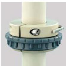
Behälter-Verschraubung zur Befestigung der Fasspumpe an beliebiger Stelle in der Behälterwand oder auch in weithalsigen Schraubverschlüssen. Die Verschraubung 2" wird mit Kontermutter 2" von innen festgeschraubt (Montagebohrung im Behälter 60 mm).
