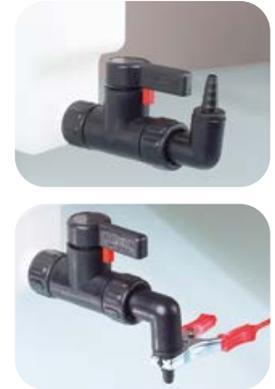
Handelsübliche Ablasshähne aus den Werkstoffen Polyethylen oder Polypropylen können nicht für Lösungsmittel eingesetzt werden. Der Ablasshahn StopCock PA ist aus elektrisch leitfähigem Polyamid hergestellt und somit für Lösungsmittel bestens geeignet. StopCock PA passt auf 3/4"-Außengewinde und mit dem mitgelieferten Adapter auf 3/4"-Innengewinde und damit auf fast alle handelsüblichen Kanister und Fässer mit Bodenablassgewinde.
