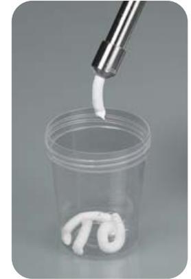
Probensammler für viskose Substanzen wie Pasten, Schlämme, Cremes, Öle. Mit der Kolbenstange wird die Probe angesaugt und wieder direkt in ein Probengefäß abgegeben. Leichte Reinigung für einwandfreie Probenahme. Je nach Viskosität kann die abschraubbare Saugspitze mit Ansaugbohrung von 2 mm bis 6 mm geliefert werden.
