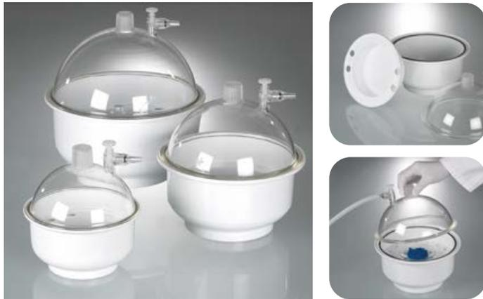
Exsikkatoren aus Kunststoff, bruchunempfindlich, leichtgewichtig und vakuumtauglich. Der Hahn ist geeignet für ein Vakuum bis -740 mmHg. Unterteil und Locheinsatz aus Polypropylen. Deckel aus Polycarbonat, glasklar mit Rückschlag- und Belüftungsventil. Abdichtung mit O-Ring aus Polychlorbutadien-Kautschuk. Dauertemperatur max. +60 °C.
