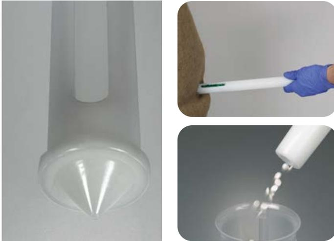
Mit TargetDispo wird eine Zielpunktprobe an einer vorher genau bestimmten Position des Probengutes entnommen. Der Sammler wird geschlossen in das Pulver oder Granulat eingestochen, und erst an der Entnahmestelle geöffnet und wieder geschlossen. Somit erhält man eine exakte Zielpunktprobe. Die Probe kann einfach über den offenen Griff entleert werden.
