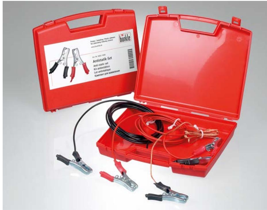
Beim Abfüllen von brennbaren Flüssigkeiten können sich bei ungenügender Erdung der Abfüllgeräte und -gebilde elektrostatische Aufladungen bilden, die bei vielen Stoffen zur Entflammung oder zur Explosion führen können. Mit dem Antistatik-Set von Bürkle lässt sich eine Erdung einfach und zuverlässig sicherstellen.
