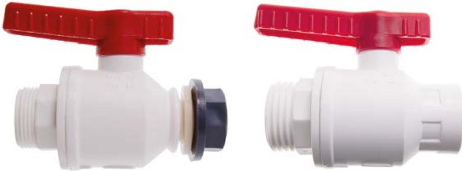
Kugelhahn aus PP mit Außen- / Innengewinde, glasfaserverstärkt, Kugel aus PP, Griff mit O-Ring aus lebensmittelechtem NBR und Dichtung aus HDPE.
