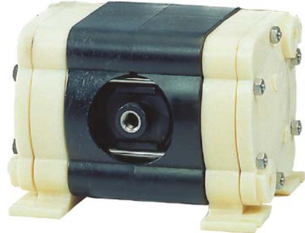
Druckluftbetriebene Doppelmembranpumpe zur Förderung von viskosen, korrosiven und abrasiven Flüssigkeiten. Pumpenausführung 1/4". Die Pumpe ist in den Werkstoffen Polypropylen, PVDF und Nylon verfügbar. Die Membranen, Kugeln und Sitze sind in Geolast, PTFE und Santopren lieferbar. Festpartikel bis 1,6 mm Ø können gefördert werden.
