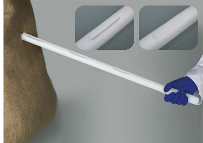
Mit dem Einweg-Allschichtsammler ZoneDispo wird in einem Probenzug eine repräsentative Allschichtprobe aus drei unterschiedlichen Schichten gesammelt. Geeignet für fließfähige Pulver und feinkörnige Granulate. Die gesammelte Probe kann im geschlossenen Probenehmer gesichert und transportiert werden.
