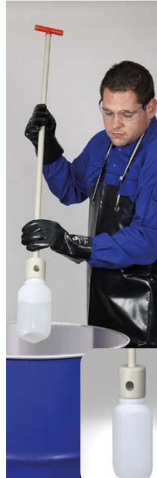
Der Probensammler ChemoSampler wurde entwickelt für die Probenahme aggressiver Flüssigkeiten, wie Säuren, Laugen, Reiniger. Die Probe fließt direkt in die aufgeschraubte Original-Probenflasche. Der Verschluss dieser Flaschen mit Originalitäts-Sicherheitsring gewährt unverfälschten Proben transport. Mit dem Verlängerungsstab können Proben bis zu einer Tiefe von 200 cm, z. B. aus Tanks, Silos oder Tankwagen genommen werden.
