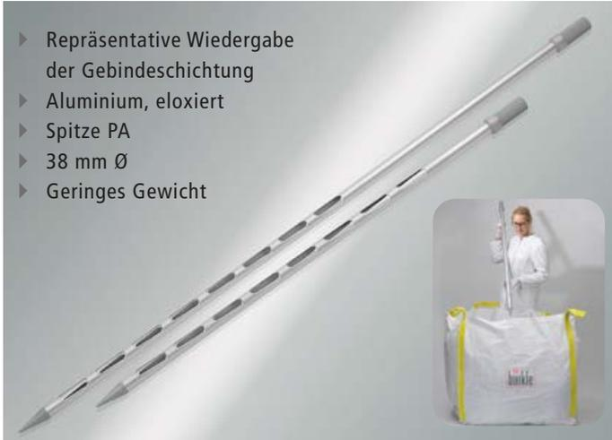
Der Zonensammler Spiralus gewährleistet eine zonengenaue Probenahme durch alle Schichten des Schüttgutes. Durch die spiralförmige Anordnung der Probenschlitze öffnen sich diese zeitverzögert von unten nach oben. Dadurch wird zuerst durch die unterste Öffnung gefüllt, und dann die darüber liegenden, bis der komplette Spiralus gefüllt ist. Die Geometrie der Probenschlitze verhindert das Zerschneiden von Körnern. Der Zonensammler Spiralus gewährt eine ausgezeichnete Allschichtprobe.
