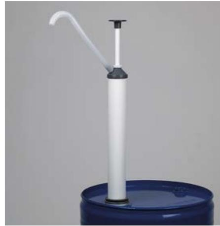
Die Kolbenpumpe für wässrige und petrochemische Produkte. Sie bietet ein gutes Preis-Leistungsverhältnis. Die Kolbenpumpe wird mittels eines 2"- oder 3/4"-Fassgewindes auf dem Abfüllgebilde befestigt. Nach der Montage lässt sich die Pumpe weiterhin um ihre Achse drehen, so können Behältnisse zum Abfüllen auch auf dem Fassdeckel abgestellt werden.
