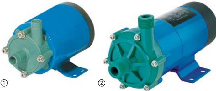
Die Magnetkreiselpumpen sind geeignet zum Fördern von Säuren, Laugen, alkalischen und galvanischen Bädern, Fotochemikalien sowie radioaktiven, sterilen und hochkorrosiven Flüssigkeiten. Durch den Antrieb über berührungslose Magnetkraftübertragung sind keine dynamischen Wellenabdichtungen erforderlich, somit ist das Pumpengehäuse hermetisch abgedichtet und lässt keine Leckagen zu.
