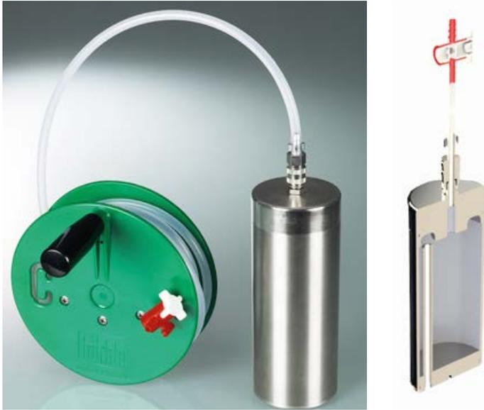
Mit der Tauchbombe Target können zielgenau Flüssigkeitsproben gesammelt werden.
