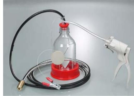
Der Probenehmer wurde speziell entwickelt für die Probenahme von brennbaren Flüssigkeiten der Gefahrenklasse A1 (VbF, z.B. Benzin). Glasflasche und Schlauch sind elektrisch leitend verbunden und werden über ein Massekabel geerdet.
