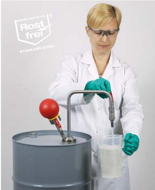
Die Lösemittelpumpe Handbetrieb ist für die kontaminationsfreie Entnahme von organischen Lösungsmitteln und aromatischen Verbindungen geeignet. Die Handpumpe arbeitet nach dem Überdruckprinzip. Mit dem Pumpenball wird ein Überdruck im Behälter aufgebaut, der die Flüssigkeit aus dem Gebinde herausdrückt.
