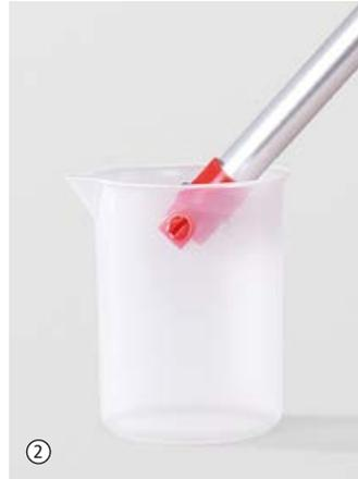
Dieser Becher pendelt sich automatisch in die Horizontale. Nichts kann verschüttet werden. Er eignet sich dadurch auch für tiefe und enge Schächte (Ø 150 mm).
