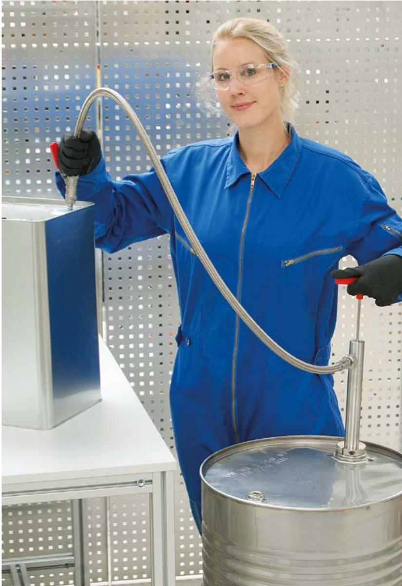
Die Bürkle Fasspumpe aus Edelstahl (1.4301) eignet sich für das Abfüllen von brennbaren und leichtentzündlichen Flüssigkeiten. Die Fasspumpe ist elektrisch leitfähig und erfüllt somit in Verbindung mit dem Antistatik-Set die Anforderungen beim Umgang mit brennbaren Flüssigkeiten.
