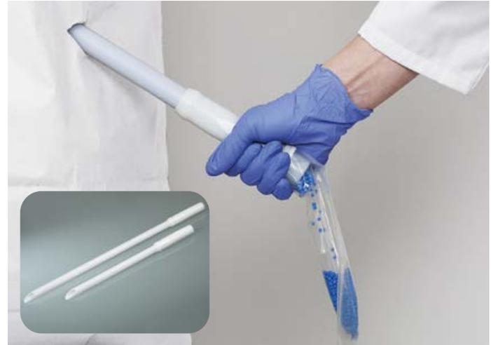
Mit dem Einweg-Probenehmer DispoLance können schnell und unkompliziert kleine wie auch größere Probenmengen direkt aus Säcken entnommen werden. Der Sammler eignet sich für fließfähige Pulver und feinkörnige Granulate. Mit der stabilen Spitze wird der Probenehmer DispoLance in das Gebinde eingestochen, die Probe fließt über das offene Innenrohr direkt in den darunter gehaltenen Behälter oder Beutel.
