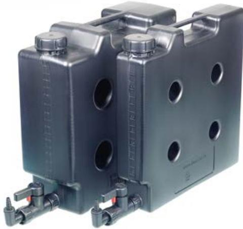
Das elektrisch leitfähige Raumsparsset besteht aus einem Raumparkanister 5 l (0435-2055) oder 10 l (0435-2105) und einem Ablasshahn StopCock PA (0525-1100). Hahn und Kanister können mittels Antistatik-Set geerdet werden und sind somit in explosionsgeschützten Bereichen einsetzbar.
