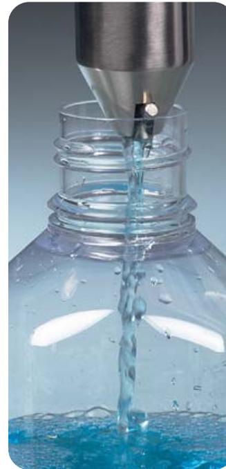
Zum Entleeren der Probe wird das Ventil durch Aufsetzen auf dem Probengefäß geöffnet.
