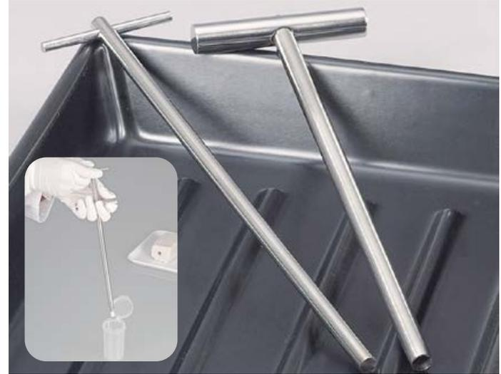
Zylindrischer Hohlbohrer mit scharfer Schneidkrone, lässt sich gut in pastöse und halb feste Substanzen einbohren. Die dabei herausgestochenen Proben werden mit dem dazugehörigen Ausstecher herausgedrückt. Gesamtlänge 260 mm. Innendurchmesser 8 mm, Außendurchmesser 10 mm.
