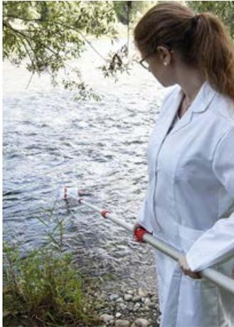
TeleSchöpfer ist ein vielfältiges Probenahmesystem mit austauschbaren Werkzeugen für verschiedenste Anwendungen. Die Werkzeuge (Winkelbecher, Pendelbecher, Flaschenhalter, Edelstahlbecher und Keschel) werden mit einer praktischen Schnappverbindung fest mit der Teleskopstange verbunden. Ideal für die Probenahme aus Becken, Tanks, Schächten, offenen Gewässern etc. Mit den längenverstellbaren Teleskopstangen aus Aluminium können Probentiefen bis zu 6 m erreicht werden.
