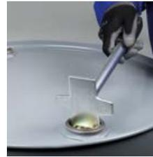
Universal-Fass-Schlüssel zum mühelosen Öffnen auch von festsitzen-den Fassverschlüssen 3/4" bis 2". Ein unverwüstliches Werkzeug aus verzinktem Stahl.
