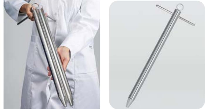
Probenstecher für Allschichtproben von viskosen, pastösen, breiartigen Substanzen, nach DIN 51750 pt. 3 und DIN EN ISO 15528. Insbesondere bei pastenartigen Stoffen bleiben unterschiedliche Schichten erhalten.
