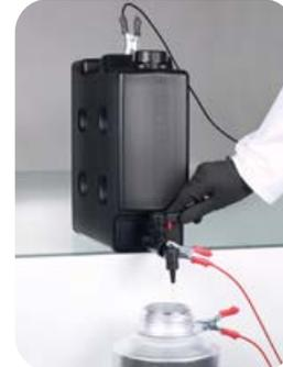
**⚠ Achtung!** Bei der Arbeit mit brennbaren Flüssigkeiten muss der Kanister geerdet sein! Antistatik-Set verwenden!
