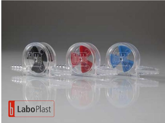
LiquiMobil Strömungswächter aus Styrol-Acrylnitril eignet sich in erster Linie in Kühlkreisläufen und hilft den Wasserverbrauch wesentlich zu senken, da der Kühlwasserdurchfluss besser eingestellt werden kann. Nicht für aggressive Flüssigkeiten geeignet.
