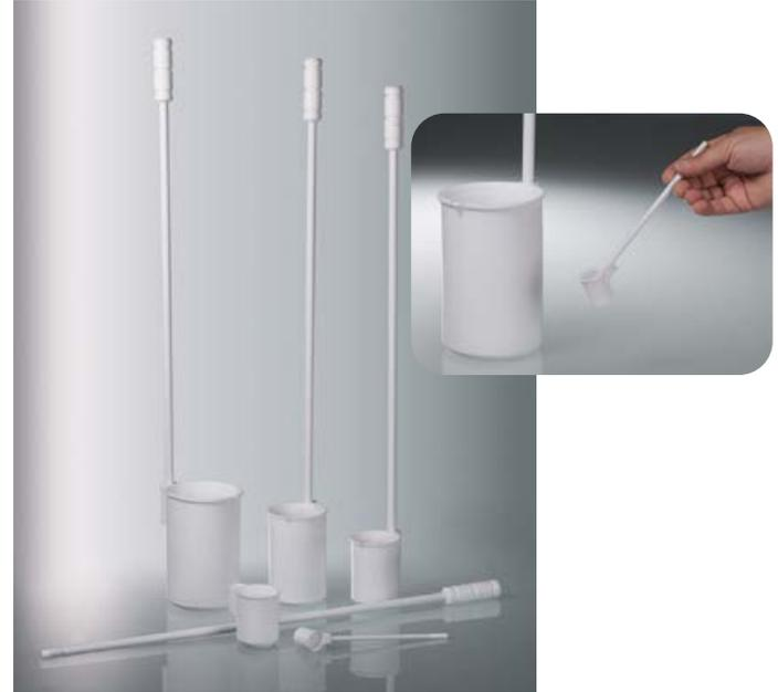
Alle mediumsberührten Teile aus reinem PTFE, weiß. Vollkommen inert gegen alle Substanzen (mit Ausnahme von elementarem Fluor). Die Stange ist mit einem Stahlkern stabilisiert und vollkommen mit PTFE ummantelt. Die 60 cm lange Stange kann um ein weiteres Element auf 120 cm Länge verlängert werden. Der Schöpfer PTFE mit 10 ml hat eine feste Stange mit 155 mm Länge.
