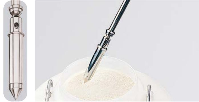
Bei hoch wirksamen, teuren oder aktiven Pulvern sammelt man nur geringe Mengen für eine Untersuchung. Mit dem PharmaPicker können kleinste Probemengen von 0,1 ml bis 2,5 ml gesammelt werden. Durch einfaches Austauschen der Volumenspitzen in den Sammelbomben für 0,1–1,2 ml oder 1,25–2,5 ml, wird das Probenvolumen verändert.
