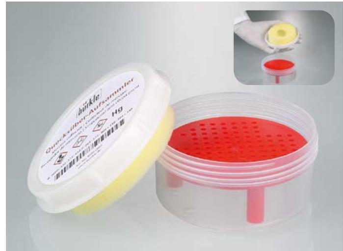
Mit dem Bürkle Quecksilber-Aufsammler kann verschüttetes Quecksilber unkompliziert aufgesammelt und wieder verwendet werden. Der Quecksilber-Aufsammler besteht aus einer Dose mit einer im Schraubdeckel eingeklebten Spezial-Schaumstoffeinlage. Drückt man die Schaumstoffeinlage leicht auf verschüttetes Quecksilber, öffnen sich deren Poren und saugen die Quecksilberkügelchen auf. Beim Zuschrauben des Deckels lösen sich die Kügelchen und fallen durch die perforierte Trennscheibe in die Dose.
