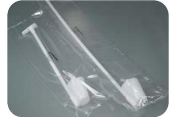
DispoSchöpfer ist ein Probenschöpfer speziell für den Einwegbedarf. Der skalierte Schöpfbecher mit erhabener Prägung ermöglicht ein Abmessen und eine Inhaltsanzeige in 10 ml-Schritten, bis zu 200 ml. Ein ergonomischer Handgriff sowie Rechts- und Links-Handbedienung durch beidseitigen Ausguss erleichtern und vereinfachen die Handhabung.
