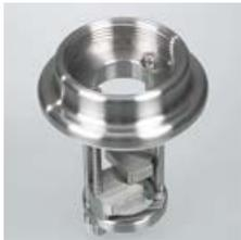
Universal Gewindeadapter für fast alle Fässer und andere Gebinde mit einer Öffnung von 48–75 mm Durchmesser, unabhängig vom vorhandenen Gewinde. Der Gewindeadapter lässt sich mit Spannschrauben schnell und einfach montieren und kann für verschiedene Behälteröffnungen verwendet werden. Mit Anschlussgewinde G2" für Bürkle Fassverschraubungen und Pumpen mit Tauchrohrdurchmesser bis 32 mm.
