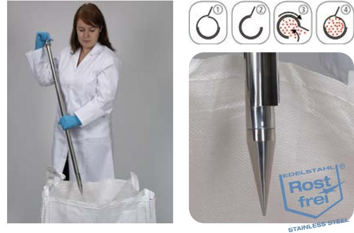
Scratcher ist speziell entwickelt für das Sammeln von kohäsiven, zusammenbackenden, nicht rieselfähigen Substanzen.
