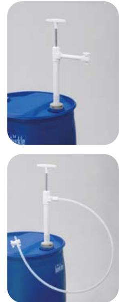
Durch die hohe chemische Beständigkeit der mediumsberührten Werkstoffe PTFE und FEP können mit dieser Fasspumpe auch Flüssigkeiten abgefüllt werden, die herkömmliche Werkstoffe wie PP oder PVC angreifen (außer elementarem Fluor). Die Fasspumpe ist auch für das Abfüllen von hochreinen Flüssigkeiten geeignet. Der Absperrhahn verhindert den Austritt gesundheitsgefährdender Dämpfe und das Nachtropfen von Flüssigkeit nach dem Abfüllen.
