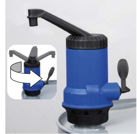
Kompakte, selbstansaugende Hebelpumpe aus Polypropylen, geeignet für leichte Säuren und Laugen. Das Teleskoprohr der Hebelpumpe ist stufenlos ausziehbar bis 100 cm, es ist somit einsetzbar für 50 – 200-l-Fässer.
