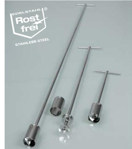
Probenehmer entwickelt für Probenahme von gefrorenen, hochviskosen, pastösen Medien wie z.B. Speiseeis und ähnlichen Substanzen. Die bohrerförmige Schneide schraubt sich beim Drehen selbstständig in das Gefriergut. Der Sammelzylinder kann über eine Bajonettverbindung leicht abgezogen werden. Die Probe liegt dann frei und kann entnommen werden.
