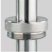
Fassverschraubung aus Messing vernickelt für die Fasspumpe Edelstahl. Verhindert elektrostatische Aufladung in Verbindung mit dem Antistatik-Set. Für das sichere Abfüllen brennbarer und leicht entzündlicher Flüssigkeiten. Für Behälter mit R 2" Stahl-Feingewinde innen.
