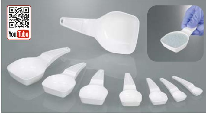
Mit den Mess- und Dosierlöffeln lassen sich kleine Mengen Pulver, Granulate und Flüssigkeiten exakt abmessen und genau dosieren. Zum genauen Abmessen wird überschüssiges Medium an der Oberkante des Löffels abgestreift.
