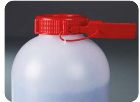
Stabile Flasche mit Plombierösen an Schraubverschluss und Flasche. Besonders geeignet für den Probenversand. Erhöhte Probensicherheit durch Plomben. Weite Öffnung, daher leicht zu befüllen. Speziell für dickflüssige Medien, Pulver, Granulate und Pasten.
