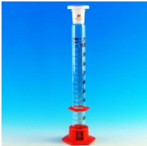
**Mischzylinder, Normalausführung, AR-Glas® (Soda-Glas), mit austauschbarem Sechskantfuß und Schutzring aus Polyethylen (PE-HD), mit NS-Deckelstopfen aus Polyethylen**
