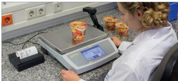
Probenprüfung einer Fertigverpackung mit Taramittelwert d. h. das relativ konstante Verpackungsgewicht ist als Festwert eingegeben
