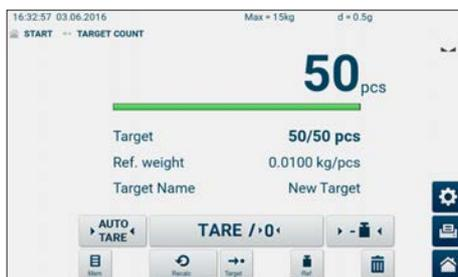
**Fill-to-target-Funktion:** Zielstückzahl bzw. Zielgewicht programmierbar, z. B. für Checkweighing. Das Erreichen des Zielwertes wird durch ein Signal angezeigt
