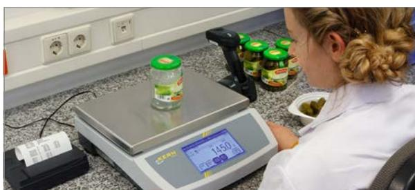
Probenprüfung einer Fertigpackung mit schwankendem Verpackungsgewicht (TARA), wie Glasgefäße, d. h. das Taragewicht wird bei jeder Probe individuell eingegeben
